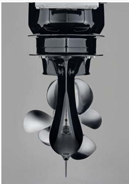
La double hélice a permis d'obtenir un profil d'embase plus fin. On aperçoit aussi les deux prises d'eau de refroidissement.
