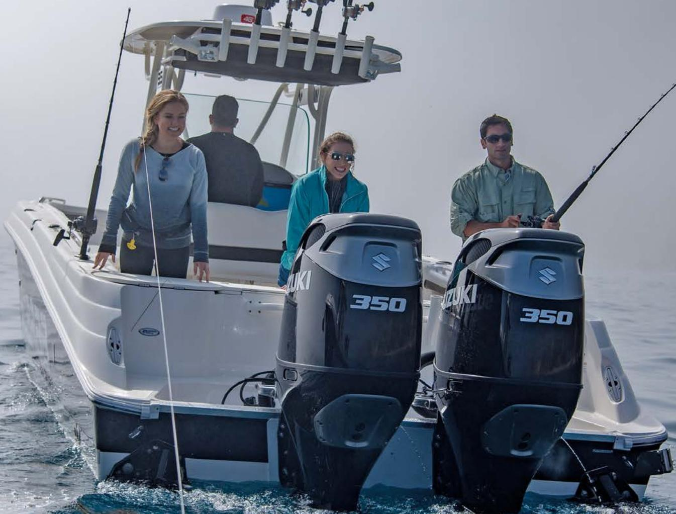
**Esthétique soignée, cylindres dopés par deux injecteurs, transmission à double hélice contre rotative, le nouveau haut de gamme de Suzuki fait la preuve par deux de la pertinence de ses innovations technologiques. Nous avons pu le vérifier sur pièce, en Floride, à l'occasion des premiers essais presse.**
